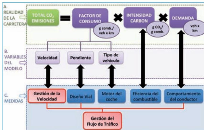
Figura 1. Estructura del modelo de emisiones de CO<sub>2</sub> de los flujos de tráfico en autopistas.
